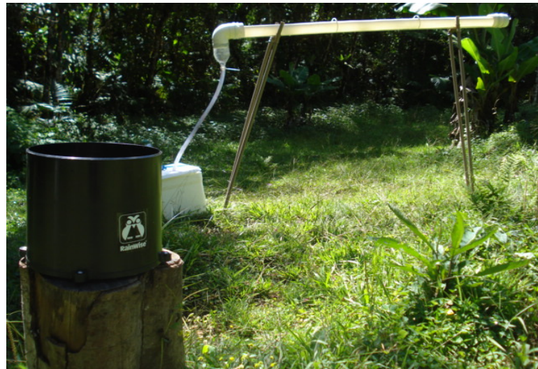
Figura 8 - Pluviógrafo Rain Wise (canto inferior à esquerda) e o coletor de precipitação para a posterir análise de nitrogênio
