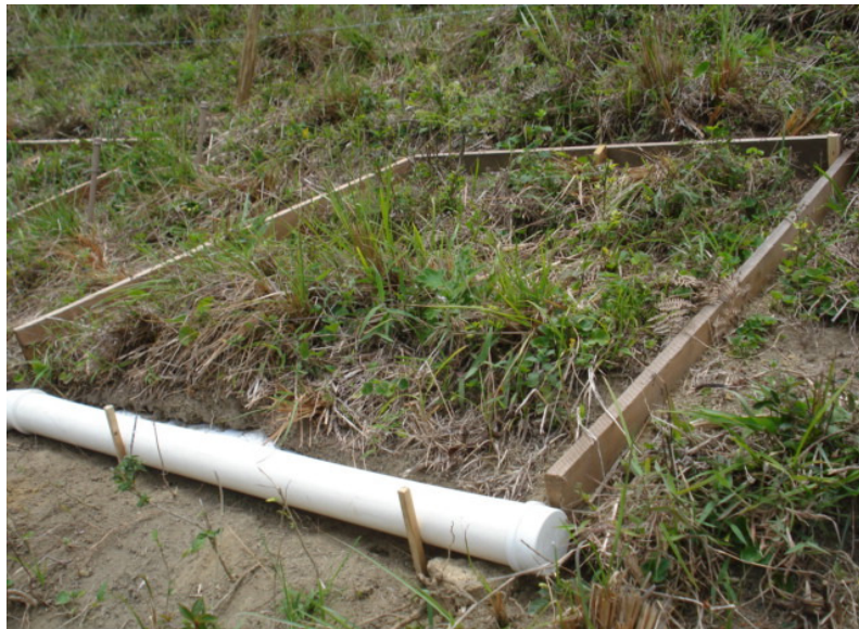
Figura 7 - Parcela de escoamento superficial não coberta por lona plástica (2,25 m 2 )
