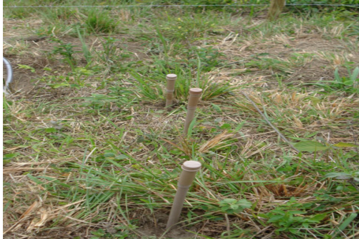
Figura 4 - Extratores de solução do solo. De baixo para cima na foto são os extratores de 90, 50 e 30 cm de profundidade
