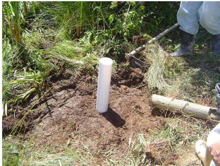
Figura 6 - Poço de observação e coleta de água do aquífero freático situado na porção adjacente ao rio
