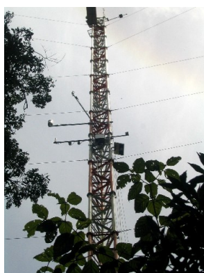
Figura 2: Torre micrometeorológica (TEC) com 60m de altura instalada em novembro de 2007 na microbacia do Ribeirão da Casa de Pedra, Núcleo Santa Virgínia, Parque Estadual da Serra do Mar – SP. Foto: Freitas, H.
