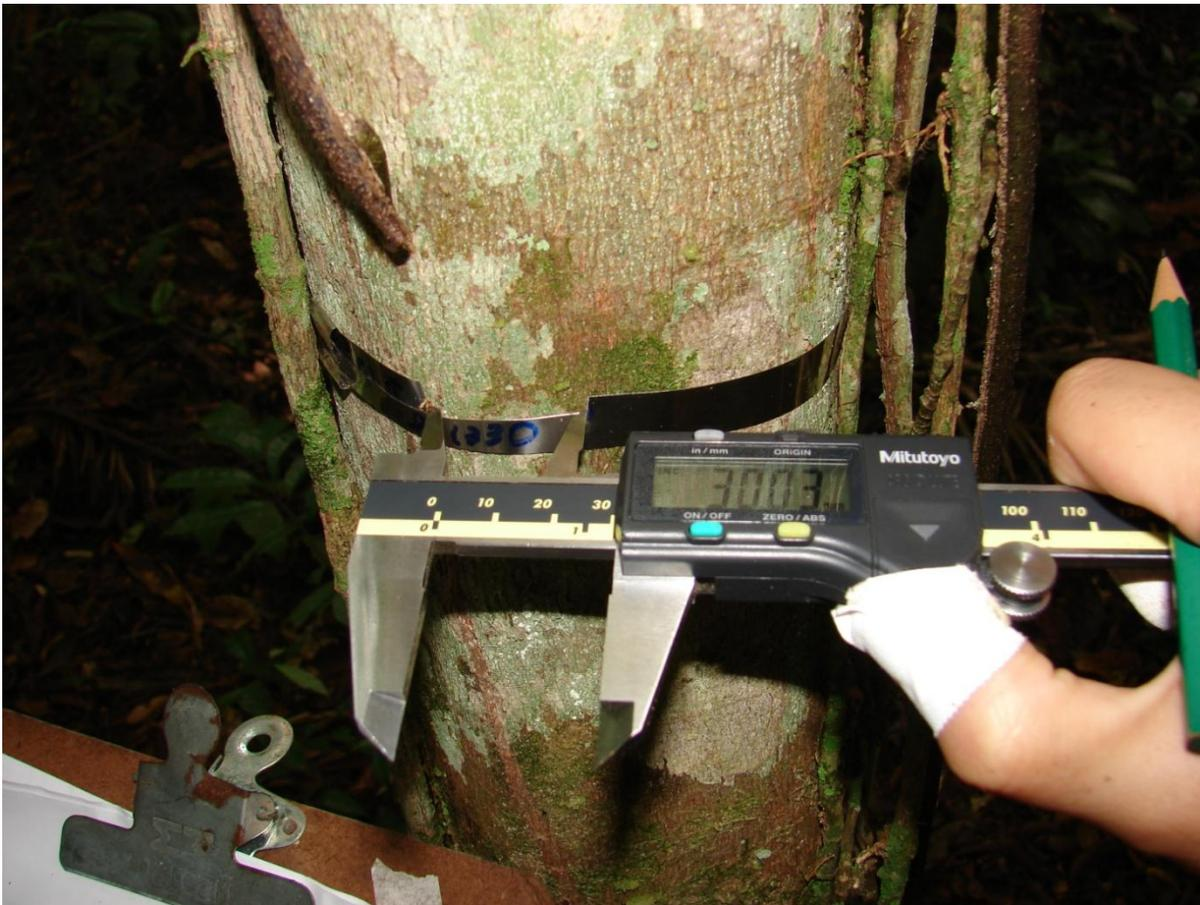
Figura 2: Fotografia ilustrando a forma como o incremento em diâmetro é medido.
