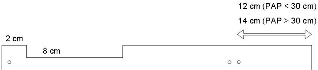
Figura 1: Modelo esquemático da cinta dendrométrica, antes de sua instalação. O comprimento total da cinta foi calculado como o PAP medido + 8 cm. A distância entre a extremidade da cinta e os furos onde se encaixam a mola depende do PAP medido, pois as molas para árvores com PAP < 30 cm são menores do que as molas utilizadas nas árvores com tamanho superior a este.
