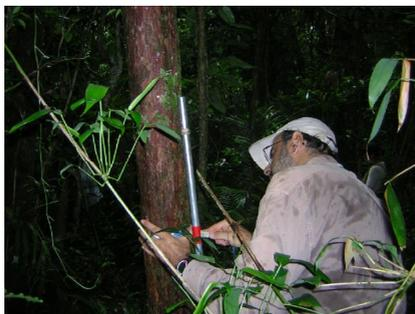
Figura 11a - Foto ilustrativa da haste de alumínio graduada utilizada no plaqueamento dos indivíduos.
