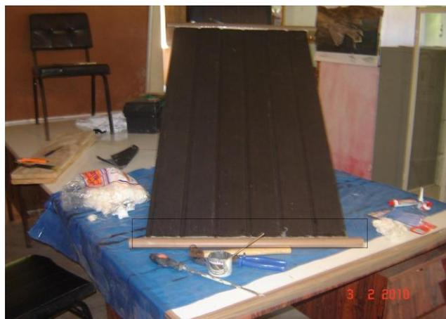
Figura 2: Placa coletora construída no LEPAC, destaque para a junção das placas com o tubo de PVC.
