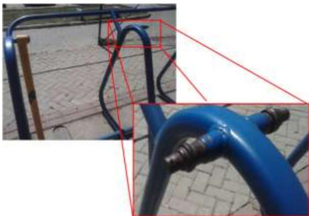
**Figura 4:** Simulador de caminhada da Praça da Paz – Paraty, faltando peças e com parafusos amostra. Esses parafusos ficaram expostos depois do aparelho perder no mínimo quatro peças fundamentais.
